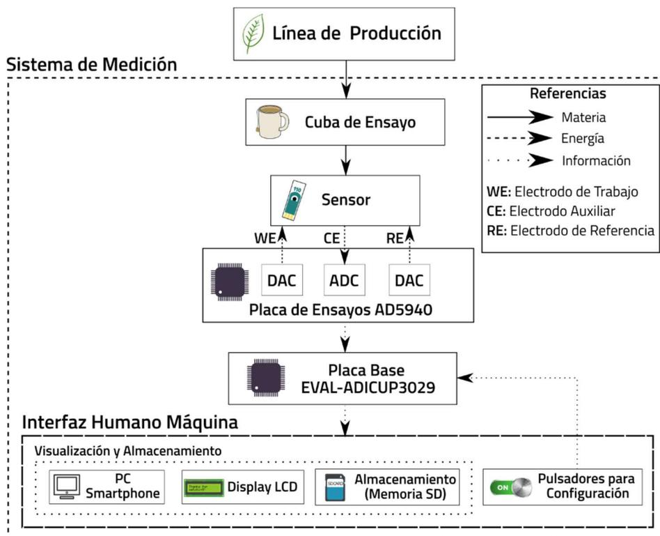
Figura 4: Esquema general del sistema de medición electroquímica.
