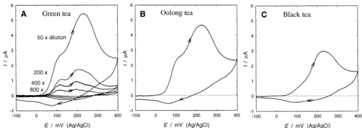
Figura 3: Voltamperogramas para distintos tipos de té
