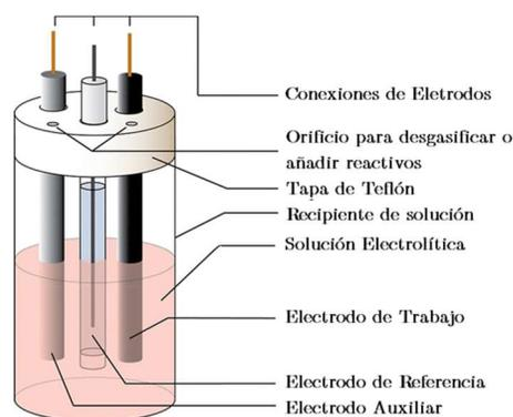
**Figura 2: Esquema general de un experimento de voltamperometría.**
