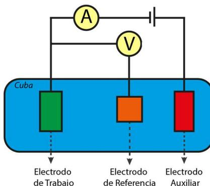
Figura 1: Esquema general de un experimento de voltamperometría.
