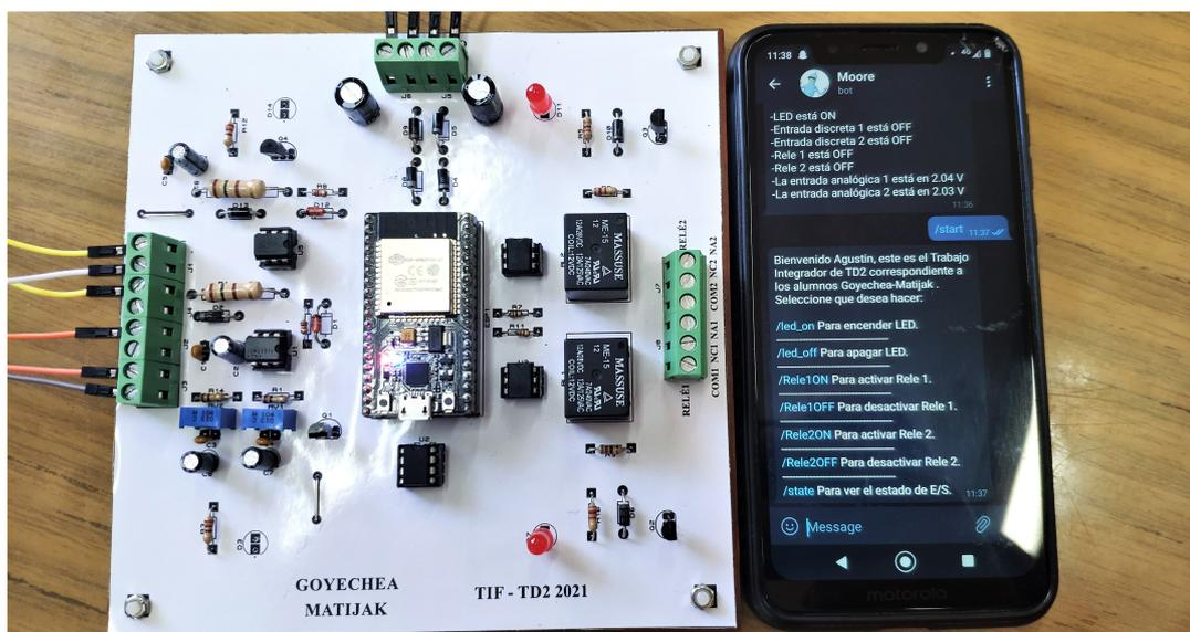
**Fig 13. Circuito final en funcionamiento junto al chat del bot.**
