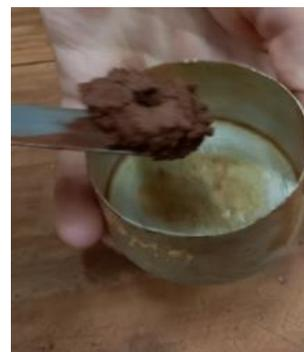
*Figura 12-Muestra del suelo extraída para posterior secado.*
