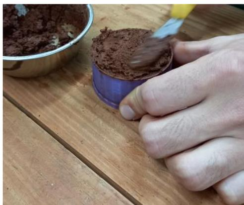
*Figura 6-Moldeo de probeta.*
