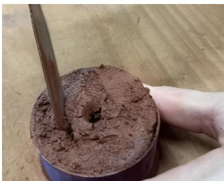
*Figura 11-Extracción de muestra de suelo.*
