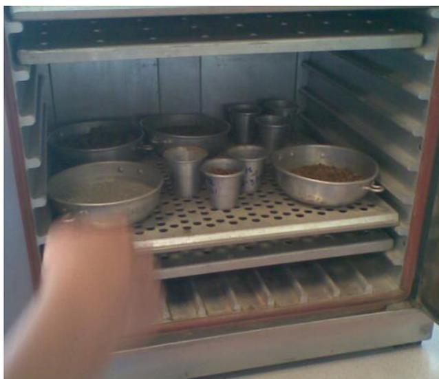
*Figura 13-Secado en horno.*
