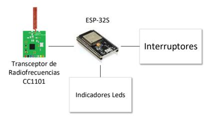
Figura 4: Esquema de conexión Tablero.
