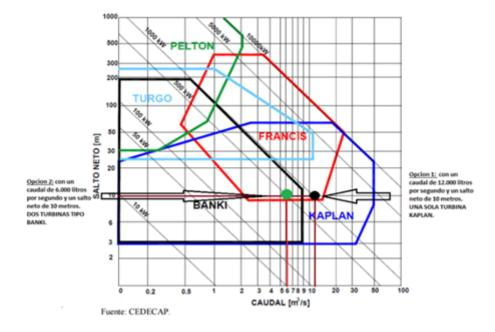
Figura 3: Regímenes de funcionamiento de turbinas
