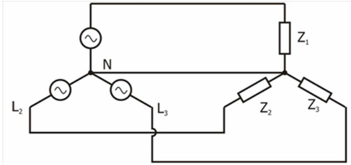
Figura 6: Circuito trifásico, motor como generador.
