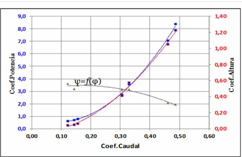
Figura 2: Coeficientes de Potencia y Altura en función del coeficiente de caudal
