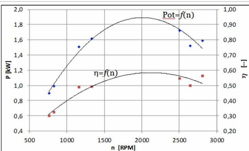
Figura 3: Potencia y rendimiento en función de la velocidad de rotación
