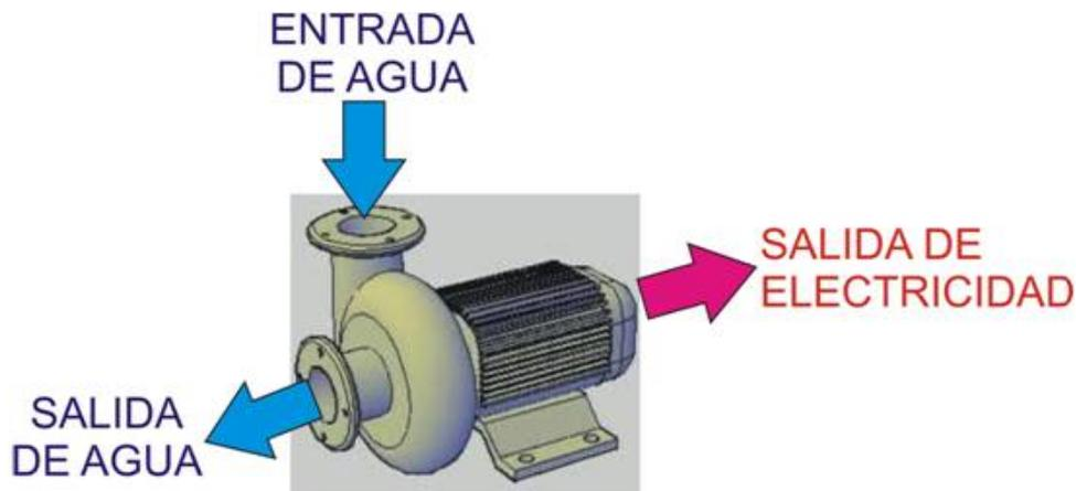
Figura 4: Entrada potencia hidráulica, salida potencia eléctrica generada
