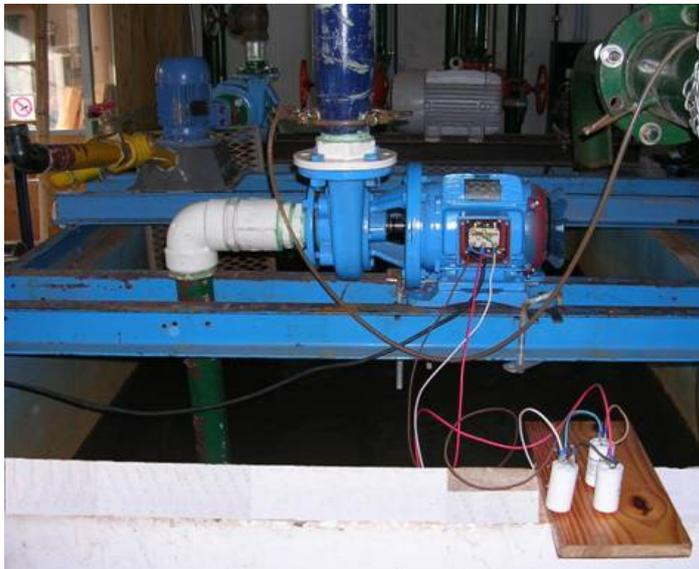
Figura 7: Bomba centrífuga como unidad generadora.
