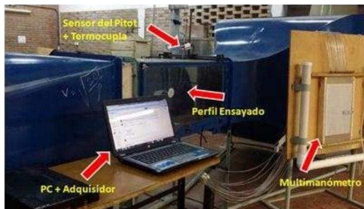
Figura 17. Túnel de Viento utilizado.
