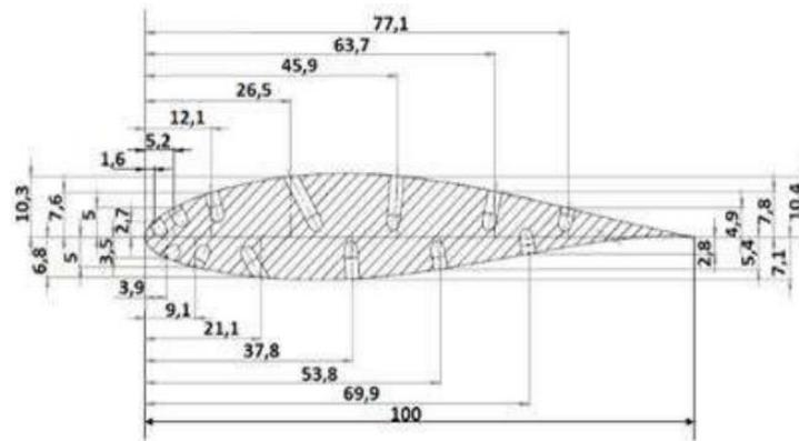
Figura 18. Modelo ensayado en [mm]
