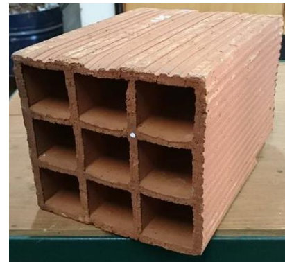
Figura 3. Mampuesto Fábrica B.
