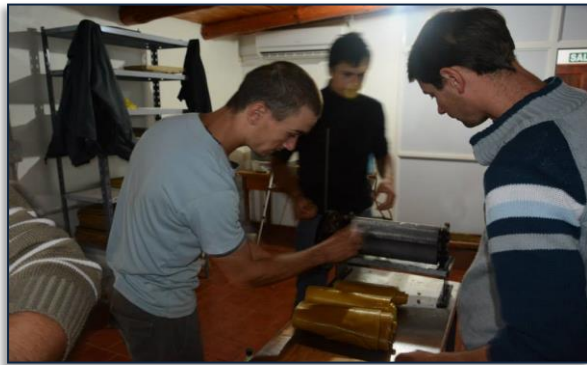
Maquina estampadora de cera de rodillos del tipo Root-Washburn utilizada en PROCAYPA - Capioví – Provincia de Misiones – Fuente: Propia Maquina estampadora de cera de prensa tipo Given utilizada en PROCAYPA - Capioví – Provincia de Misiones – Fuente: Propia
