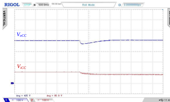
(a) Variación de la tensión de salida del boost debido a un escalón de potencia lineal de 1,6 a 3,2 kW.
