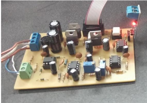
Figura 4: Placa de sensado.
