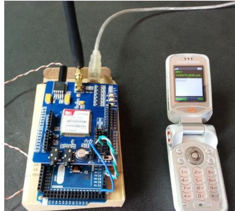
Figura 5: Prueba del modulo de comunicaci3n.
